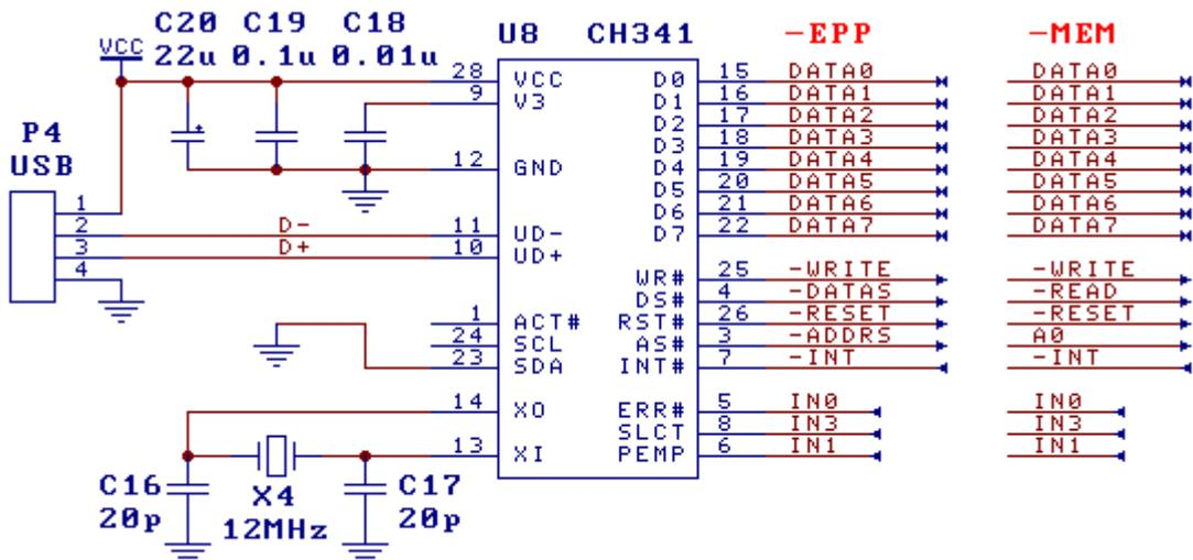
在设计印刷电路板 PCB 时, 需要注意: 退耦电容 C18 和 C19 尽量靠近 CH341 的相连引脚; 使 D+ 和 D-信号线贴近平行布线, 尽量在两侧提供地线或者覆铜, 减少来自外界的信号干扰; 尽量缩短 XI
